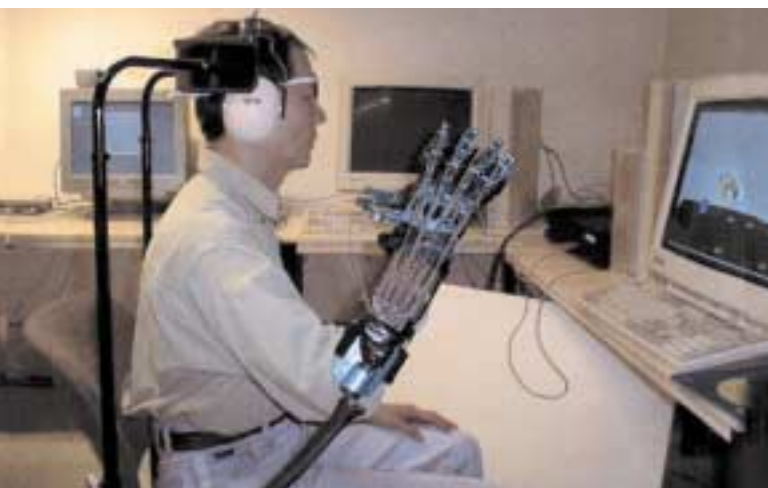
Gants à retours d'effort : manipulation dans un monde virtuel avec retours sensitifs, auditifs et haptiques.
