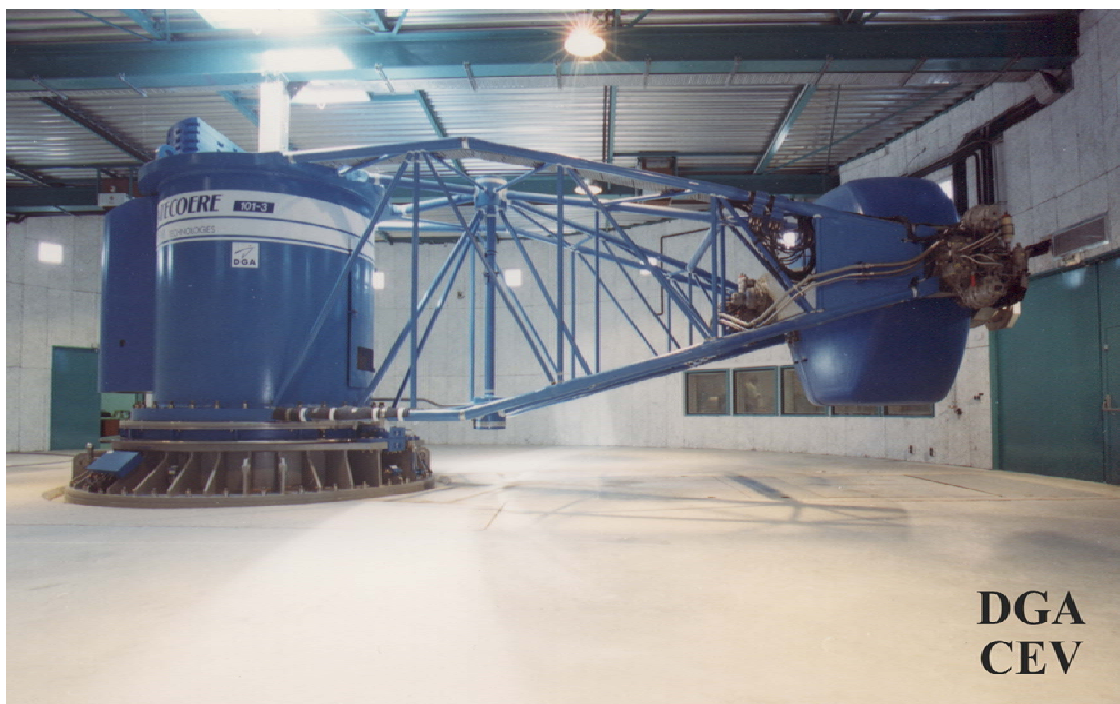
Fig. 3 La nouvelle centrifugeuse du CEV
