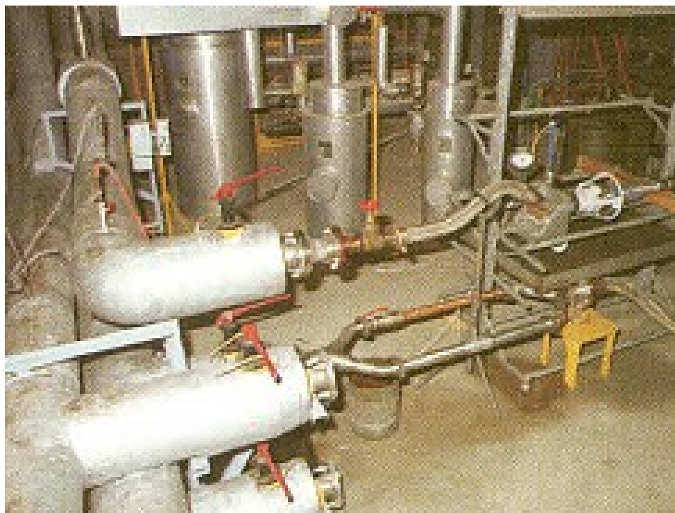
Fig. 24 Essai de givrage de système de ravitaillement en vol
