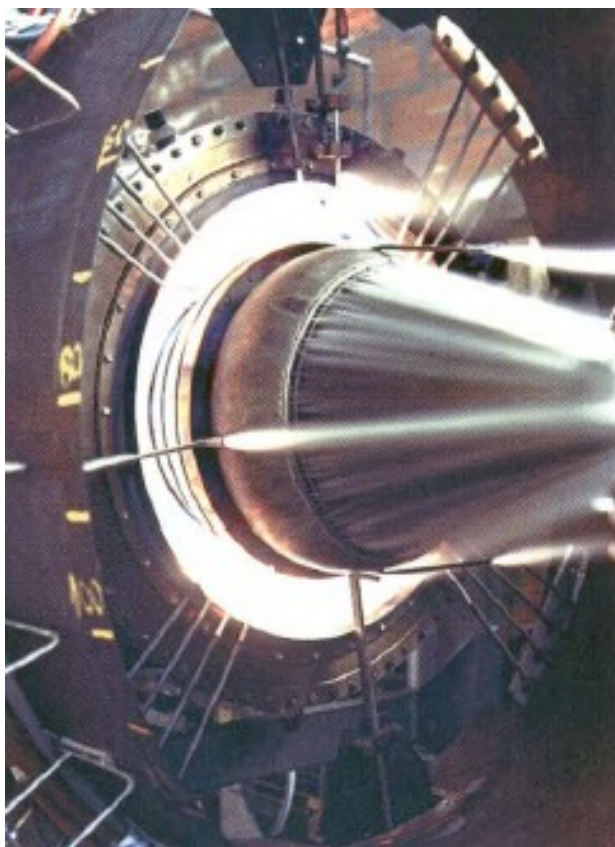
Fig. 15 Chambre de combustion en essais
