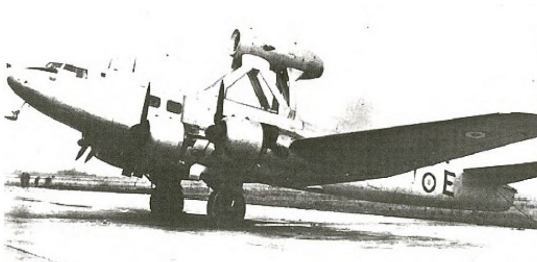
Fig. 2 Banc volant Bloch 161 Languedoc pour essais ATAR
