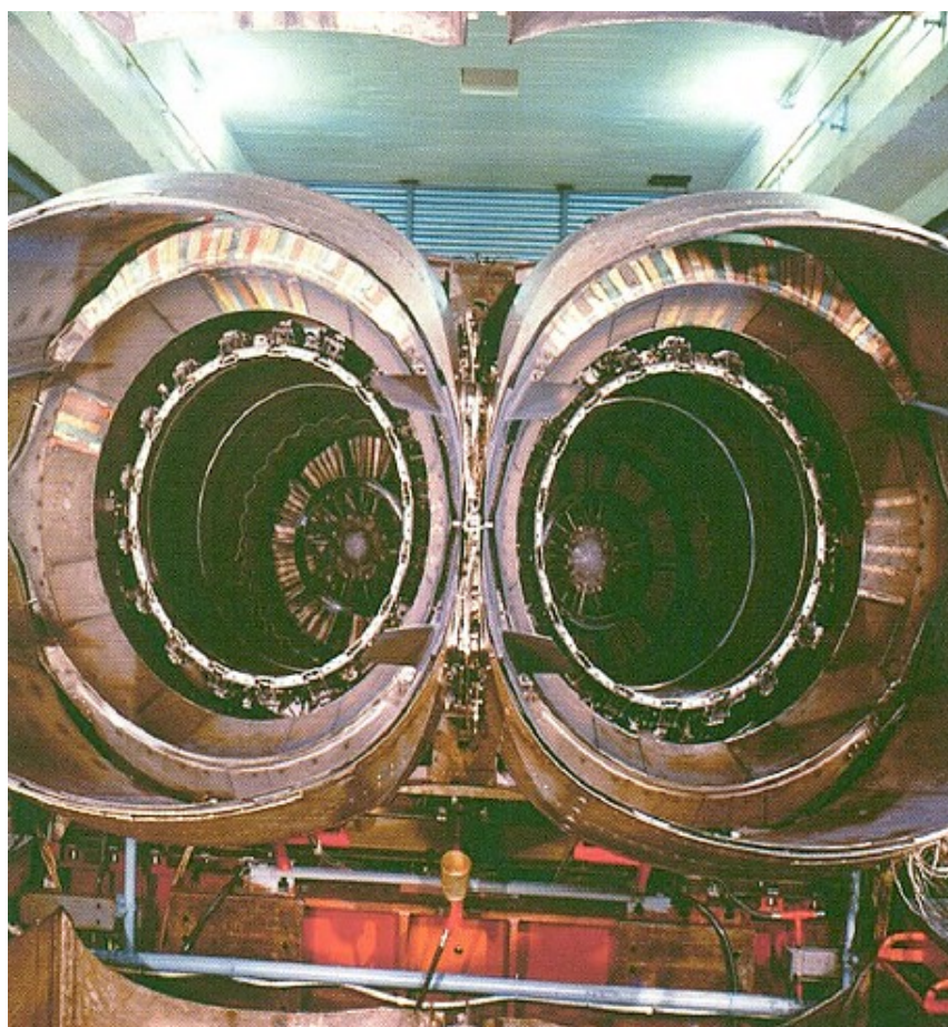
Fig. 20 Deux Olympus 593B en essais simultanés au banc T1
