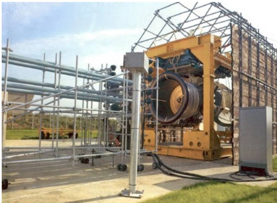
Fig. 29 CFM56 au banc TX face à un canon multitubes
