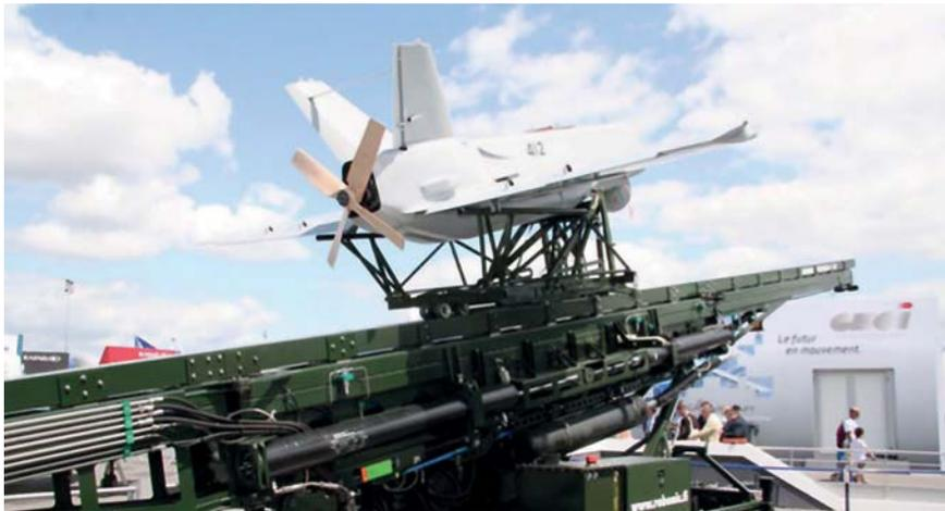
Figure 1 : Drone SDTI (Système de drone tactique intérimaire) sur lanceur Robonic.
