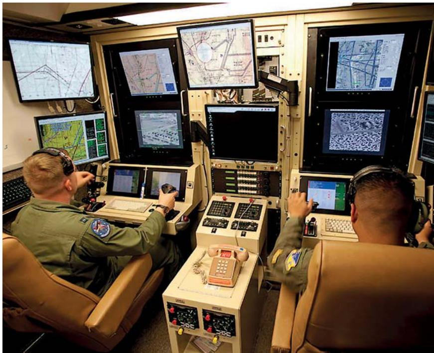
Figure 4: Pilotage d'un Predator depuis une station au sol.
