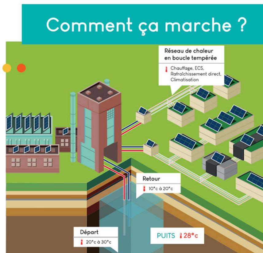
Fig. 1.5. Stockage dans les eaux d'une mine ennoyée. Source : [10]
