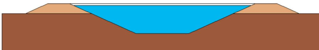
Fig. 1.6. Vue en coupe d'un réservoir de stockage en fosse (PTES). Source : PlanEnergi via [9]
