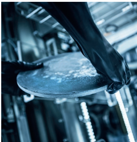
Disque de Composite McPhy permettant de stocker 600 litres d'hydrogène © McPhy Energy.
