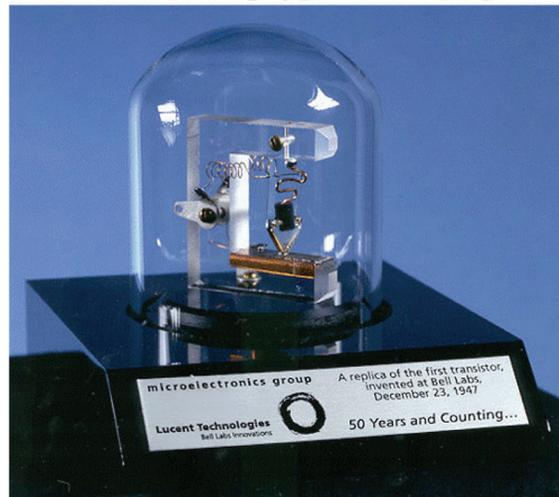
Figure 1: Image du premier transistor réalisé en 1947 dans les laboratoires Bell aux États-Unis, inventé par les chercheurs américains William Shockley, John Bardeen et Walter Brattain dont les travaux ont été reconnus par un prix Nobel de Physique en 1956.
