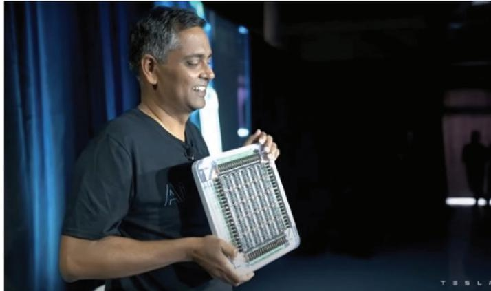
Figure 17 : Tuile « Dojo ». 120 tuiles de ce type constitueront le superordinateur « Dojo » construit par Tesla pour apprendre à conduire à ses voitures.
