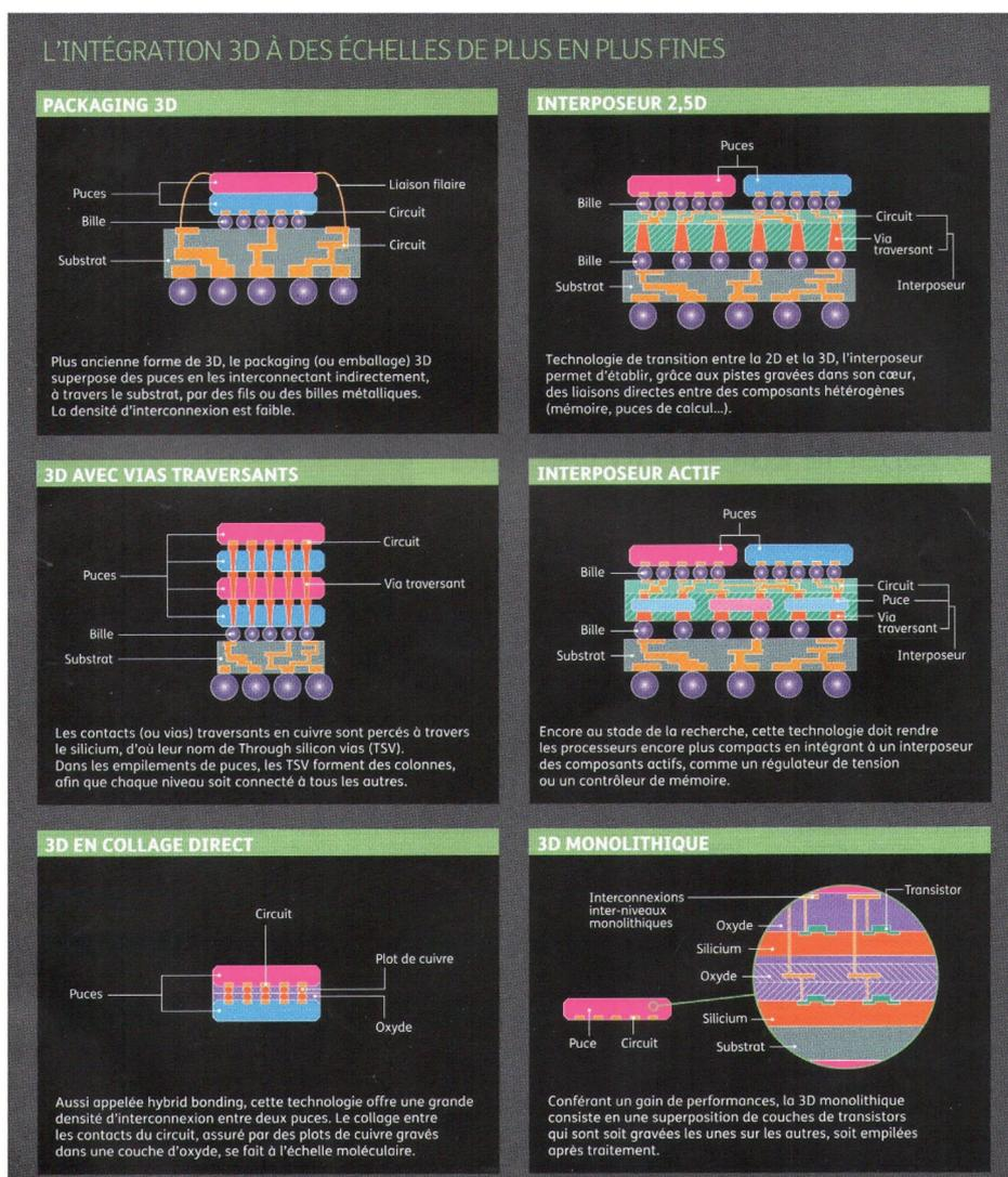
Figure 13 : ces schémas présentent les principales technologies actuelles permettant d'empiler des puces en 3D
