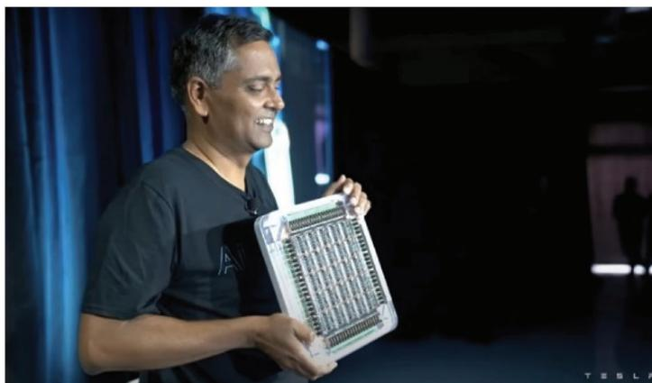
Figure 17 : Tuile « Dojo ». 120 tuiles de ce type constitueront le superordinateur « Dojo » construit par Tesla pour apprendre à conduire à ses voitures.
