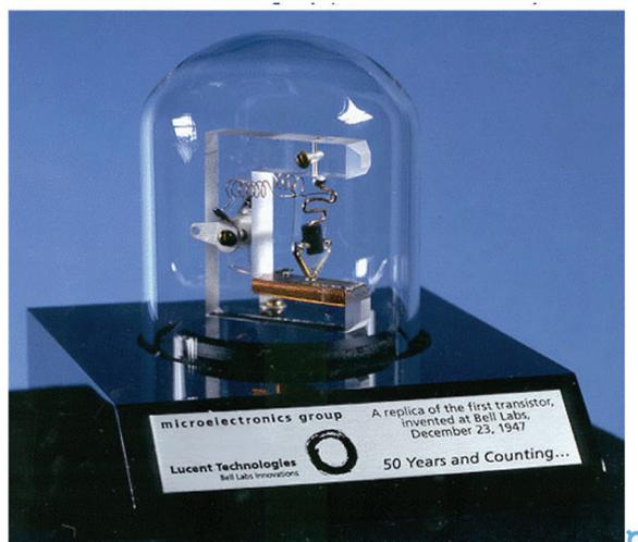
Figure 1: Image du premier transistor réalisé en 1947 dans les laboratoires Bell aux États-Unis, inventé par les chercheurs américains William Shockley, John Bardeen et Walter Brattain dont les travaux ont été reconnus par un prix Nobel de Physique en 1956.
