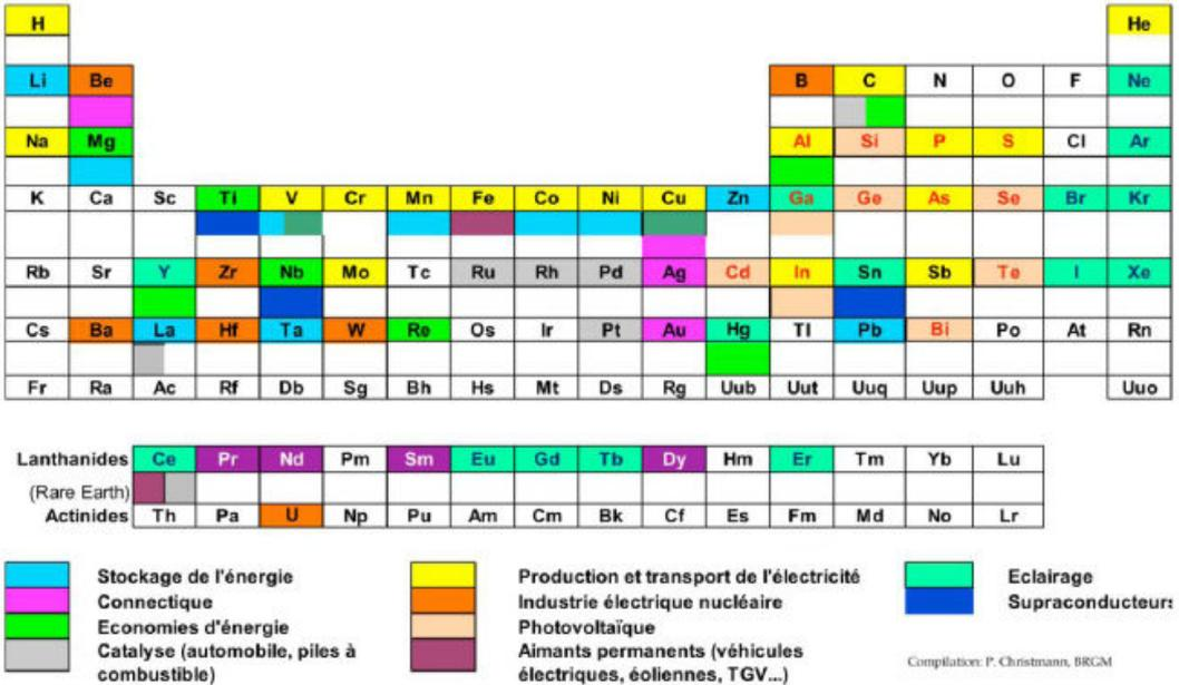
Figure 1 : éléments nécessaires à la transition énergétique
