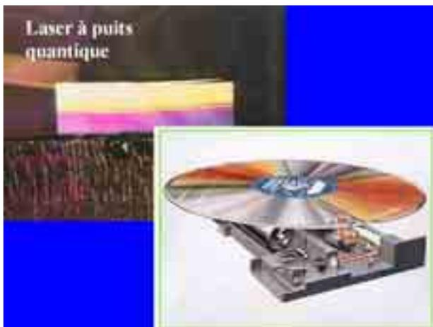
*Laser à puits quantique* : ce dispositif, dont le cœur est constitué d'un agencement de couches de semi-conducteurs de quelques nanomètres, a permis la mise au point des dispositifs de lecture et d'enregistrement numérique pour le grand public.
