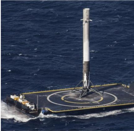
Source : SpaceX, barge de récupération du 1<sup>er</sup> étage de Falcon 9
