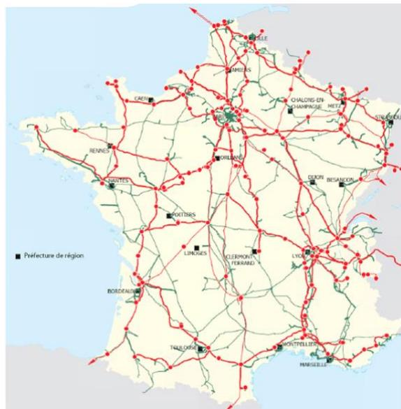
Figure 2 : Le réseau du transport 400kV et 225 kV [7]
