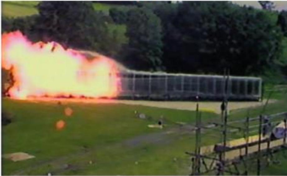
A gauche : flamme d'hydrogène ancrée sur un réservoir haute pression. A droite : propagation d'une explosion dans un canal
