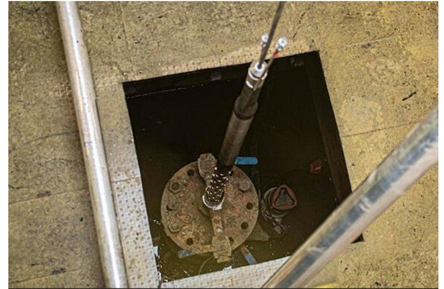
La sonde SysMoG™ positionnée avant la descente dans le forage. Le dispositif a été miniaturisé pour qu'il puisse être introduit dans un puits de 6 cm de diamètre
